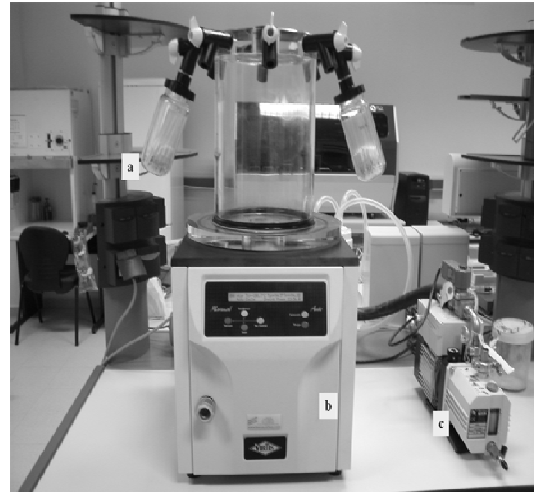
Fig. 1. Liofilizador de laboratorio. Los frascos conectados a la cámara de vacío contienen tubos con bacterias en proceso de liofilización (a). También se muestra la ubicación del condensador (b) y la bomba de vacío (c).
