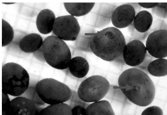
Fig. 4. Agregación del consorcio microbiano en granos que pueden llegar a medir un par de milímetros de diámetro. Con las flechas se muestran puntos de ventilación, por los que escapa el biogas producido (Tomado de: www.uasb.org/discover/granules.htm ).
