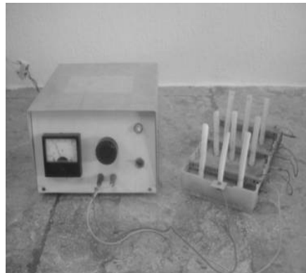
Fig. 2. Equipo de Electroterapia para la aplicación de corriente. Reg. Patent. 37/95 AO.1C/08 Res.1524/97. OPIC. Cuba.
